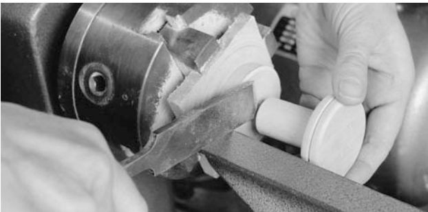
11.7 Stechen Sie mit der spitzen Spitze des schrägen Flachmeißels ab; halten Sie das Werkstück, und ziehen Sie es sanft nach hinten
