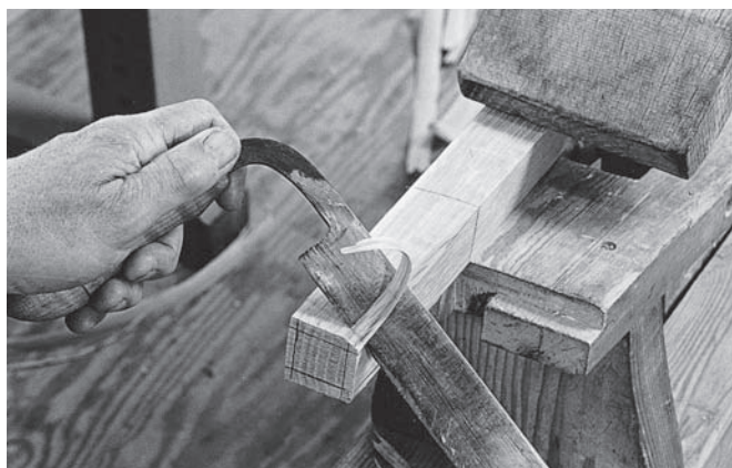
Bearbeiten der Fläche nach dem konischen Anfasen der beiden Kanten des Pfostens.
