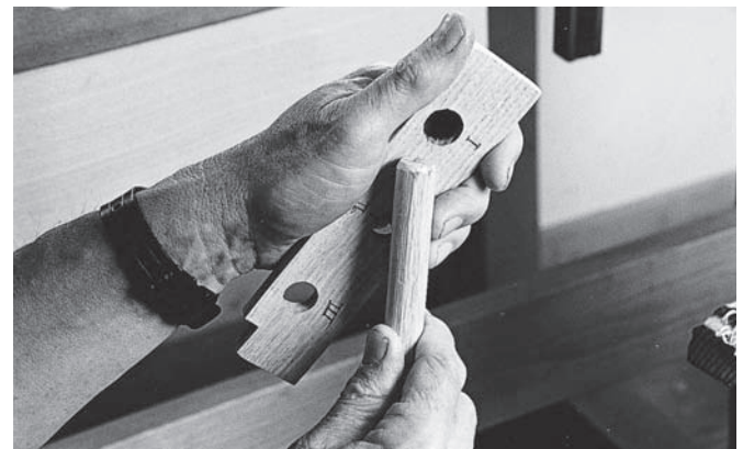
Abb. 6.16 Typisches Sprossenende nach dem Trocknen. Bearbeiten Sie das zu große Maß auf 18 mm.
