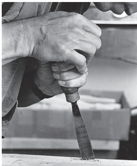
Säubern der Flanken mit dem Stecheisen. Drücken Sie mit der Schulter und führen die Schneide schräge.
