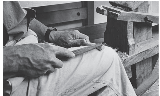
Das Feilen einer kleinen Fasse am Ende einer Sprosse. Rollen Sie die Sprosse auf dem Schenkel zu sich, während Sie gleichzeitig die Feile nach vorn bewegen.
