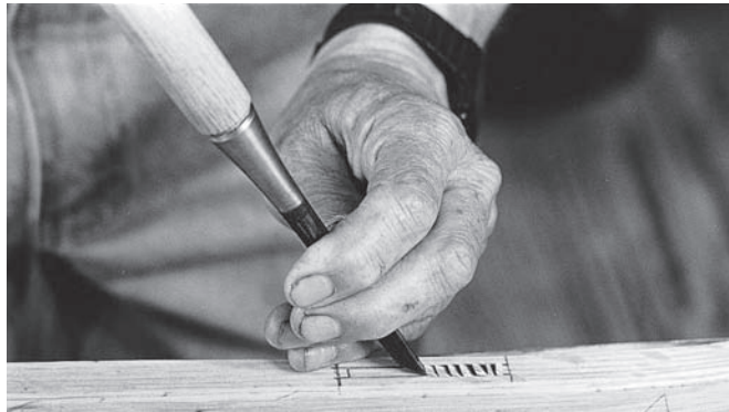
Eine Reihe von Einstichen innerhalb der Anrisse, Beitelphase nach unten. Schlagen Sie nur leicht mit dem Hammer.
