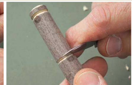
Schneiden Sie weiter unten, etwas oberhalb der Stelle, an der die Spatelklinge beginnen soll, eine weitere Rille in den Griff.
