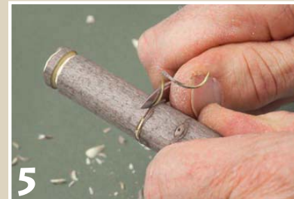
Schneiden Sie weiter unten, etwas oberhalb der Stelle, an der die Spatelklinge beginnen soll, eine weitere Rille in den Griff.
