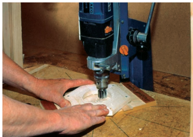
Abb. 21: Zum Sauberfräsen der Innenkreise wird die Zentrierbühne mit der aufgesetzten Drehbühne und dem darauf verschraubten Etagenrahmen mit Schraubzwingen auf dem Fräsständer und der Werkbank befestigt.
